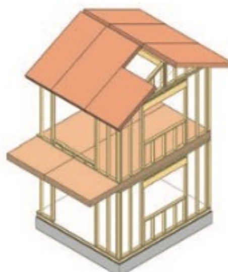
枠組壁工法+CLT
